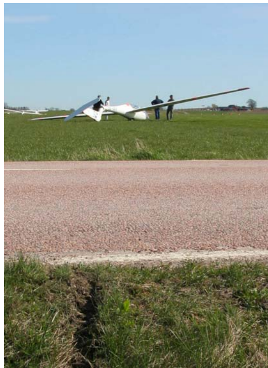
Bild 2 visar flygplanets islag i vägbanken
